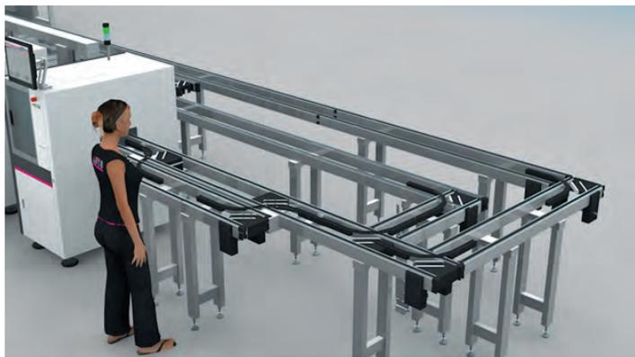
Конвейерная система TESTON выполнена в модульной конструкции, что обеспечивает гибкость использования, заключающуюся в возможности реконфигурации под различные нужды. Система может быть интегрирована как с модулями INVENTUS, так и с иным in-line оборудованием. Также система TESTON позволяет организовывать ручные рабочие места монтажников.
